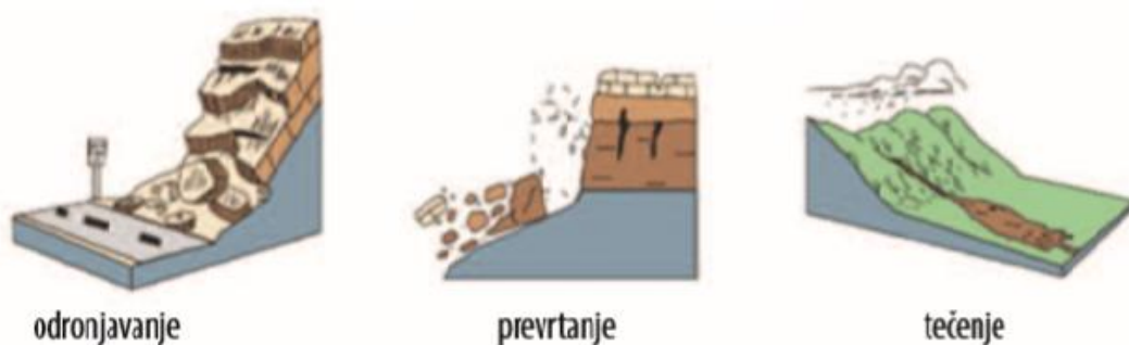
Slika 24: Prikaz osnovnih tipova klizanja prema mehanizmu kretanja
